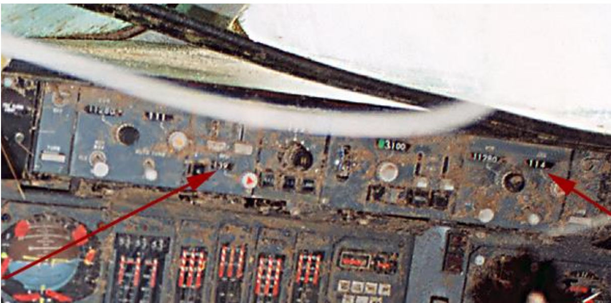
Cockpit MP 495: Naast de verkeerde naderingssnelheid van 139 kts is ook de instelling van de VFA VOR met frequentie 112.8 zichtbaar en de radiaal 111° aan de zijde van de gezagvoerder en 114° bij de F/O.
